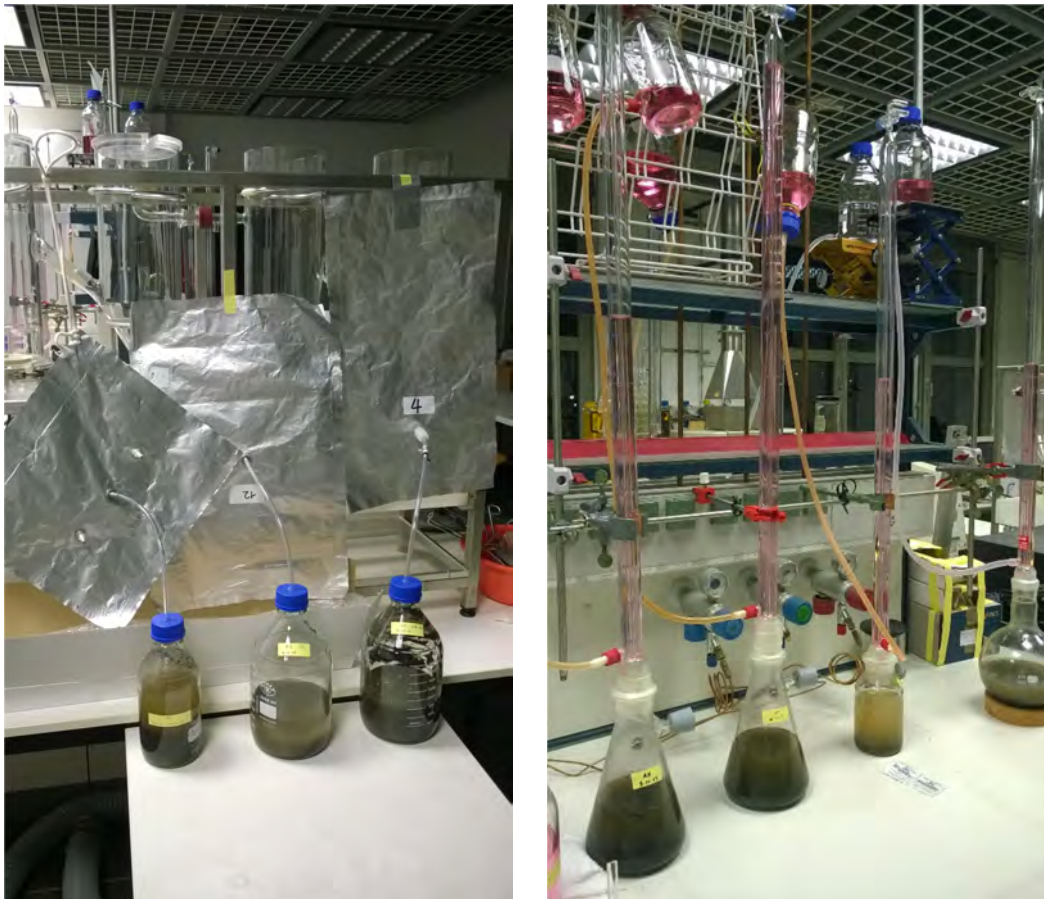
Abbildung 26: Versuche zur Bestimmung der Gasbildungsrate mittels Gasbeuteln (links) und Eudiometern (rechts)
