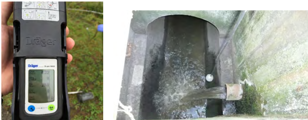
Abbildung 8: Eingesetztes Messgerät X-am 5600 der Fa. Dräger mit Wasser- und Staubschutz, selbstansaugend mit externer Pumpe für Gasmessungen
