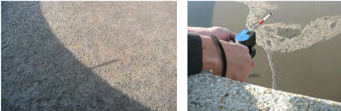
Abbildung 11: Schlammstapel mit Gasblasen und ohne Rühren, Kläranlage SN
