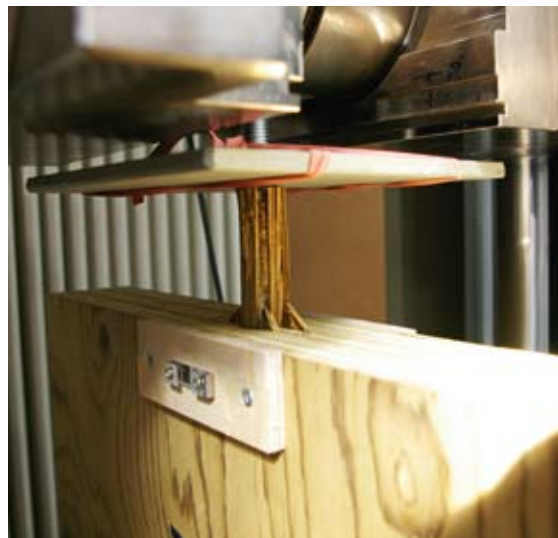
Abb. 5: Prüfkörper mit Herausziehen der Gewindestange.
