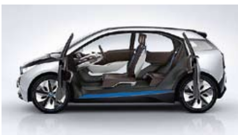
Abb. 6: BMW i3 „Mega City Vehicle (MCV)“, Karosserieaufbau aus CFK (Quelle: BMW).
