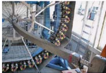
Abb. 4: Herstellung eines CFK-Spantprofils im Flechtverfahren (Quelle: Forschungsverbund IMAC-PRO).
