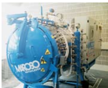
Abb. 11: Heißpresse im Faserverbundlabor der HSA.
