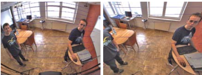
Abb. 1: Kamera-Bild mit Linsenverzerrungen (links) und korrigiertes Bild (rechts) (vorgestellt auf der embedded world 2012).
