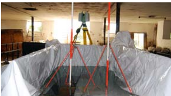
Abb. 5: Prüfbecken für den Unterwasserscan.
