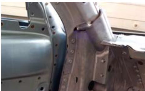
Abb. 7: Fügeverfahren und Klebnahtrichtung (Bildmitte) am Beispiel des AUDI TT (A-Säule) Quelle: [eigenes Foto]
