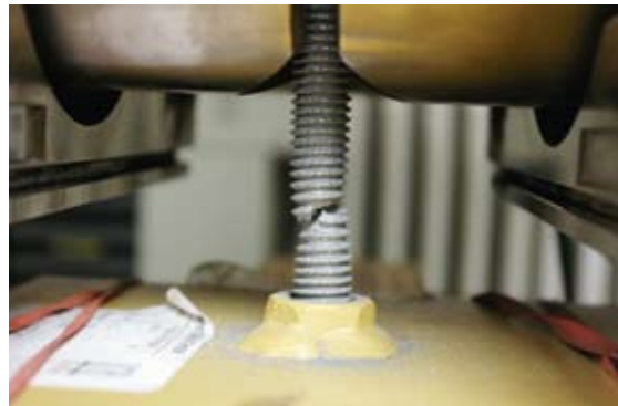
Abb. 4: Prüfkörper mit Zugversagen der Gewindestange.
