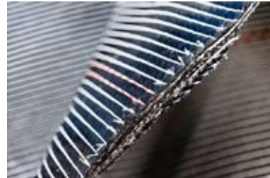
Abb. 5: Textiles Halbzeug aus Carbonfasern, dreidimensional vernäht (Quelle: BMW).
