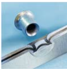
Abb. 3: Halbhohlstanznieten Aluminium Stahl Aluminium Quelle: [Böllhoff 2012]
