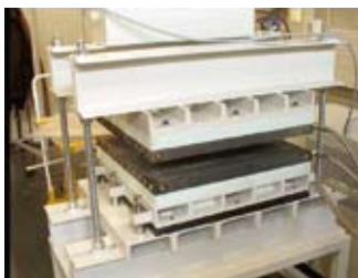
Abb. 11: Heißpresse im Faserverbundlabor der HSA.
