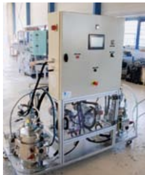
Abb. 13: RTM-Harz-injektionsanlage (hier im Werk) für das Faserverbundlabor der HSA.
