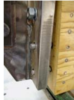
Abb. 10: „Abstreifen“ der Muttern (links) und Zugversagen der Stangen (rechts).
