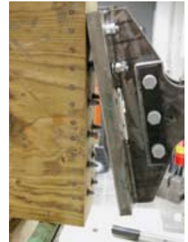
Abb. 10: „Abstreifen“ der Muttern (links) und Zugversagen der Stangen (rechts).
