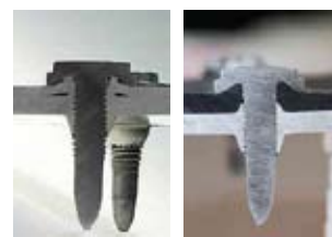
Abb. 5: Fließformschraubverbindungen links: Aluminiumblech (dünn) Aluminiumstrangpressprofil (dick) rechts: Faserverbundkunststoff (weich) Aluminiumprofil (hart) Quelle: [Ejot 2012]
