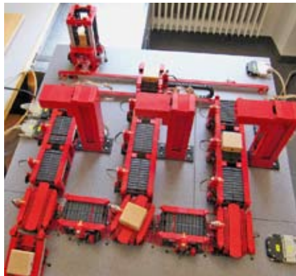
Abb. 2: Modulares Industrieanlagenmodell zur Stückgutfertigung
