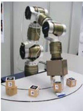
Abb. 3: Intelligente Greiferkamera in Aktion. Der Roboterarm kann selbstständig Objekte erkennen und ergreifen. (vorgestellt auf den ExpertDays Service Robotics, 29.2.–1.3.2012)
