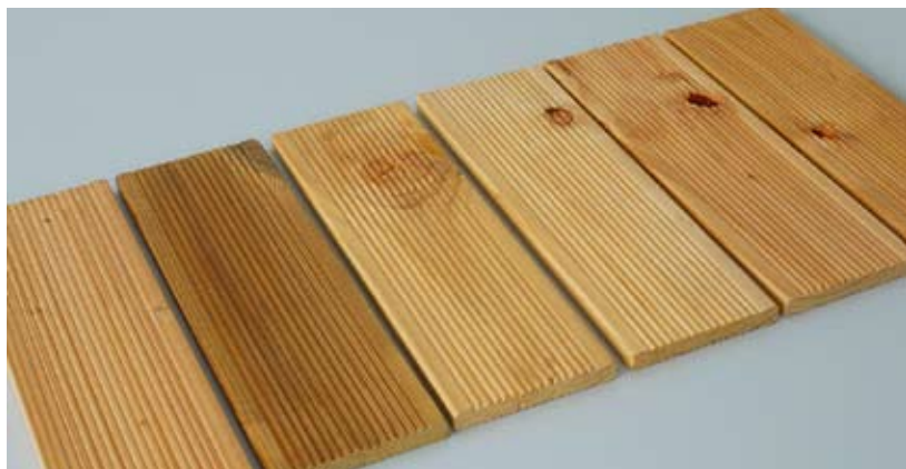
Abb. 2: Stichprobenentnahme aus der Materialbeistellung für den Montageprozess. Deutlich erkennbar sind unterschiedliche Helligkeiten sowie verschieden ausgeprägte Maserungen bis hin zu massiven Schädigungen der Oberfläche und Astlöchern.
