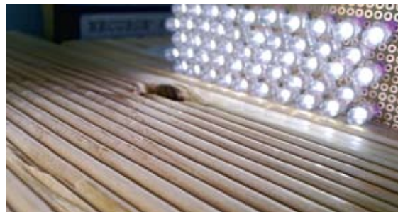
Abb. 5: Oberflächenvermessung und Defektkontrolle mittels Vollbildanalyse und Werkstückausleuchtung in Dunkelfeldanordnung.
