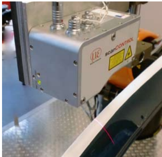
Abb. 1: Laserscanner basierte Bahnführung eines Industrieroboters sowie gleichzeitige Vermessung von Freiformen und Prüfmerkmalen an einer frei im Messraum platzierten Autotüre.
