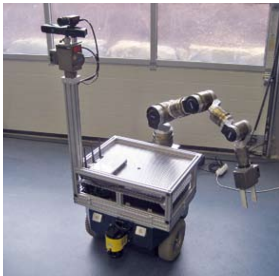
Abb. 5: Modularer Leichtbauarm auf einer mobilen Plattform (Foto: Fa. Schunk).
