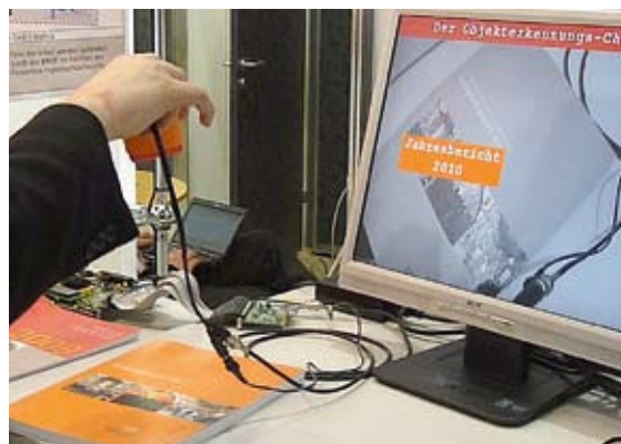
Abb. 2: Der Objekt-Erkennungs-Chip in Aktion: Ein Jahresbericht der Hochschule wird anhand natürlicher Merkmale erkannt und beschriftet.
