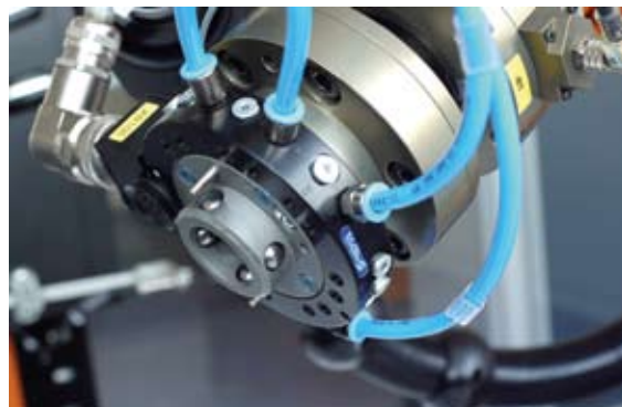
Abb. 4b: Wechselgreifervorrichtung mit pneumatisch-mechanischer Fixierung.
