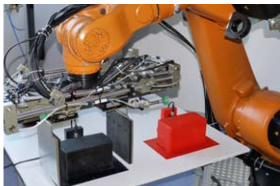
Abb. 3b: Roboter Demoaufbau mit RFID gesteuerter Werkstückidentifikation, Roboterparametrierung und Kraft-Momenten rückgekoppeltem Multifunktionsgreifer.
