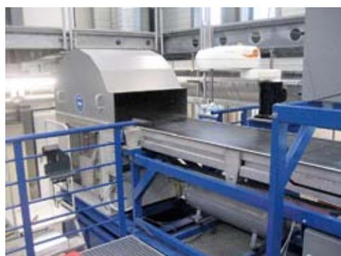
Abbildung 5: Anlage ohne Schutztür im Roboterbereich.
