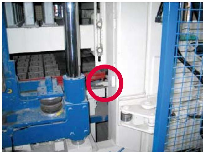
Abbildung 3: ISM Band Funksensorsystem mit Haftmagnet, hier an einem Rahmen fixiert.
