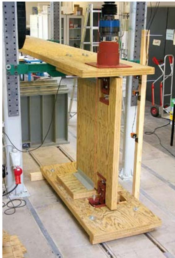
Bild 5: Prüfkörper im Knickversuch
