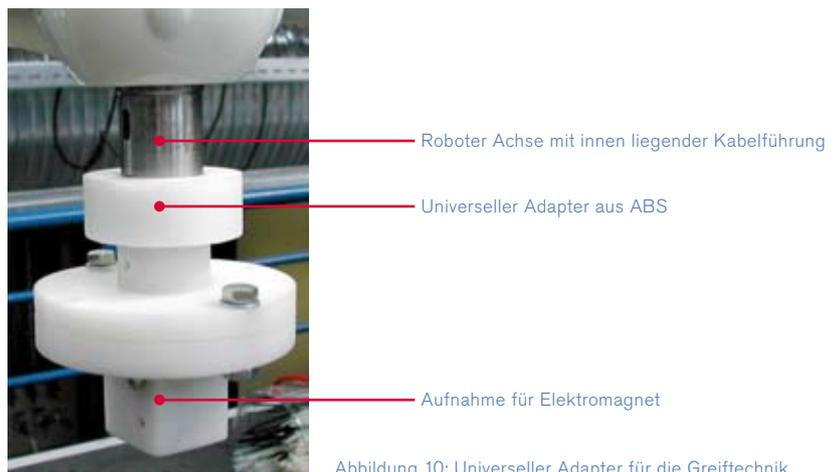
Abbildung 10: Universeller Adapter für die Greiftechnik.
