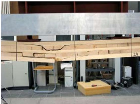
Bild 1 Versuchsträger aus Brettspertholz
