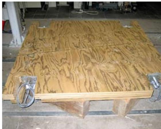
Bild 3: Prüfkörper zur Ermittlung des Kriechverhaltens von vorgespannten Bauteilen aus Furnierschichtholz
