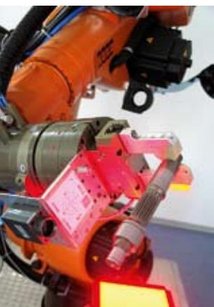
Bildverarbeitung und Robotik kombiniert: Vision Guided Robotics
