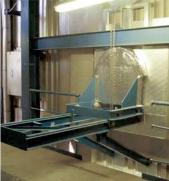
Abb. 3.1 Grundgestell des Versuchsstandes
