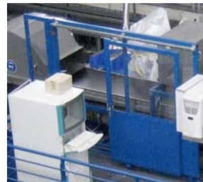
Abbildung 6: Anlage mit Schutztür im Roboterbereich.
