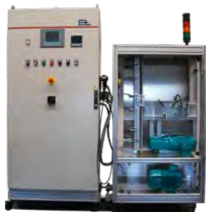
Versuchsmaschine und Schaltschrank im Labor für Automatisierungstechnik.
