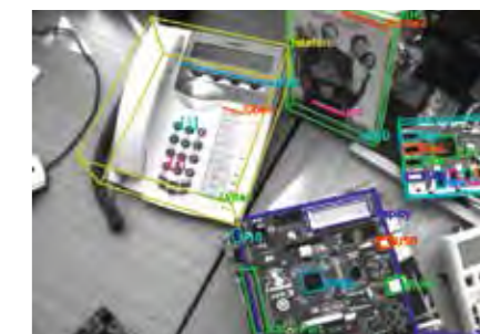
Objekterkennung und Tracking der Position mit eingebetteter Hardware.
