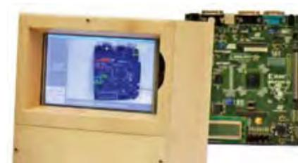
Abbildung 4: MARS in einer Schulungsanwendung. Das Experimentier-Board aus dem Labor im Hintergrund wird automatisch vom System erkannt, und die Anschlüsse werden passend beschriftet. (vorgestellt auf der *embedded world 2012* und *Go-3D 2012*)
