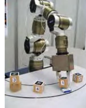
Intelligente Greiferkamera in Aktion. Der Roboterarm kann selbstständig Objekte erkennen und ergreifen. (vorgestellt auf den *ExpertDays Service Robotics*, 29.2. – 1.3.2012)
