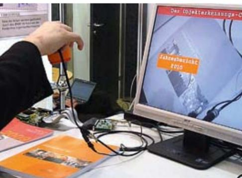
Demonstrator auf der embedded world 2011: Die von der Kamera aufgenommenen Bilder werden in einem Embedded-System ausgewertet, welches vorab erlernte Objekte erkennt und markiert. Das gesamte System ist in einem einzigen FPGA-Baustein als System-On-Chip realisiert.
