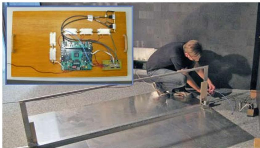
Aufgebaute Sendeantenne für Schienenradar, klein: Radardemonstrator
