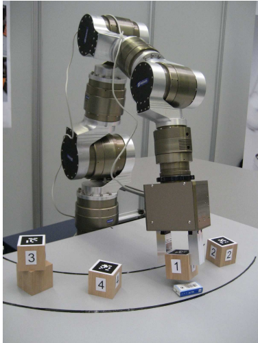
Würfelsortieren mit Hilfe einer intelligenten Greiferkamera, Expertdays Servicerobotik 2012
