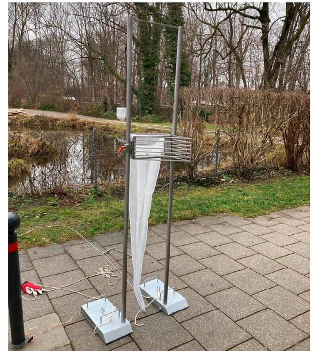
Zum Test bereit: Die Messeinrichtung zur Erfassung von Mikroplastik in Fließgewässern.
