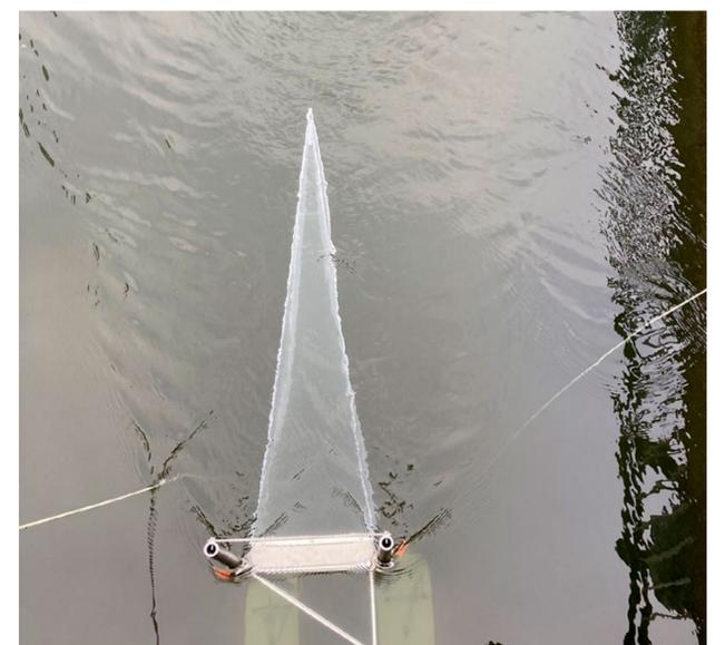
Im Test am Hanreibach in Augsburg: Ob Mikroplastik-Partikel im Wasser sind, lässt sich mit dem Kescher erproben.
