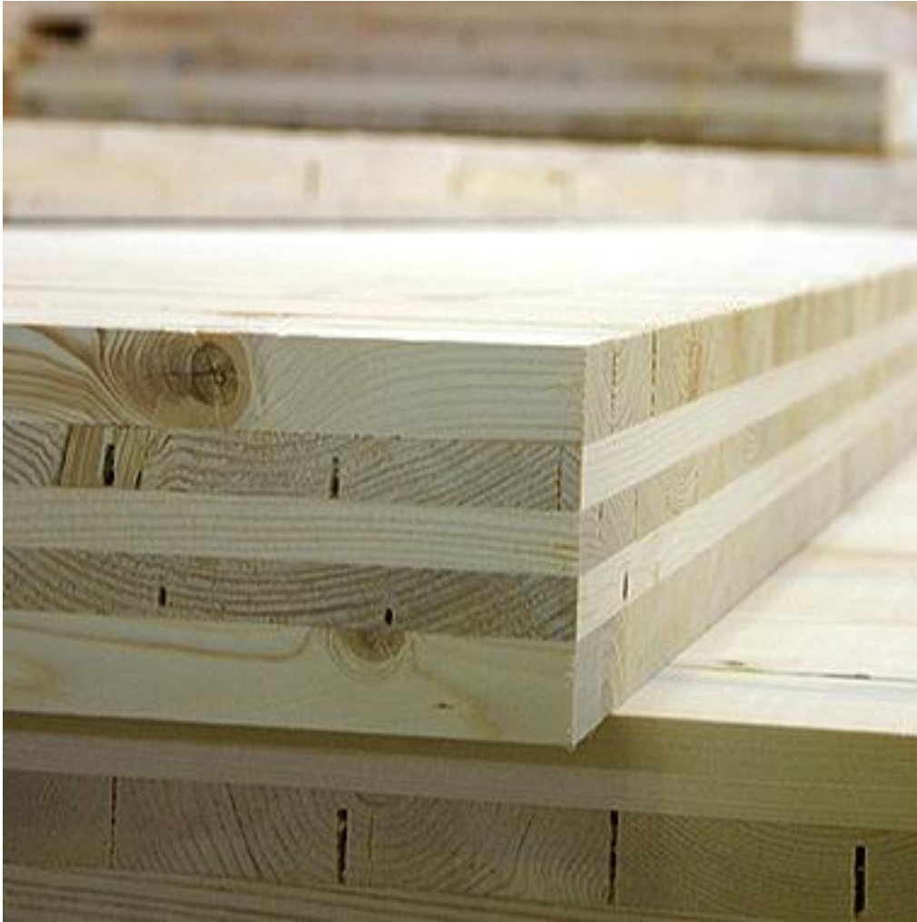
Brettspertholz Quelle: Züblin Timber
