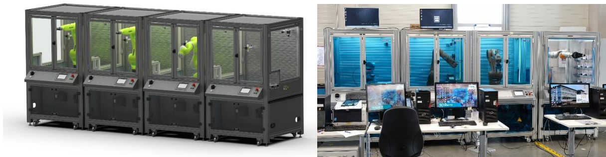
Abbildung 8: Handhabungszellen TTZ Nördlingen (links: Digitales Modell, rechts: reale Instanz)
