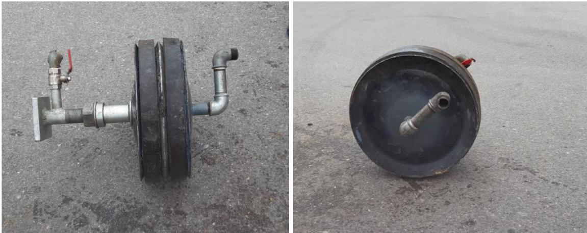
Abbildung 66: Modifiziertes Absperrorgan zum Verschluss der Leitung Zirndorf
