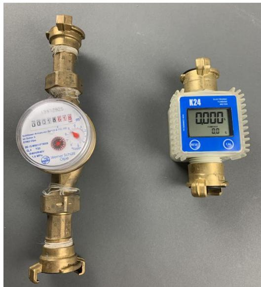
Abbildung 10: Verwendete Wasserzähler: analoger Einstrahl-Etagenzähler ETK 115 T der Firma Werner Schütz (links) sowie digitaler Wasserzähler Modell K24 (rechts)
