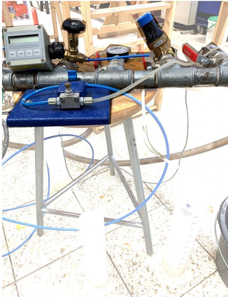
Abbildung 27 Versuchsaufbau für die Bestimmung des Zusammenhangs zwischen Differenzdruck und Leckagevolumen
