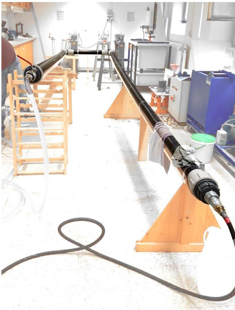
Abbildung 6: Testleitung aus PE-100, OD 90, SDR 11 im Labor der Hochschule Augsburg
