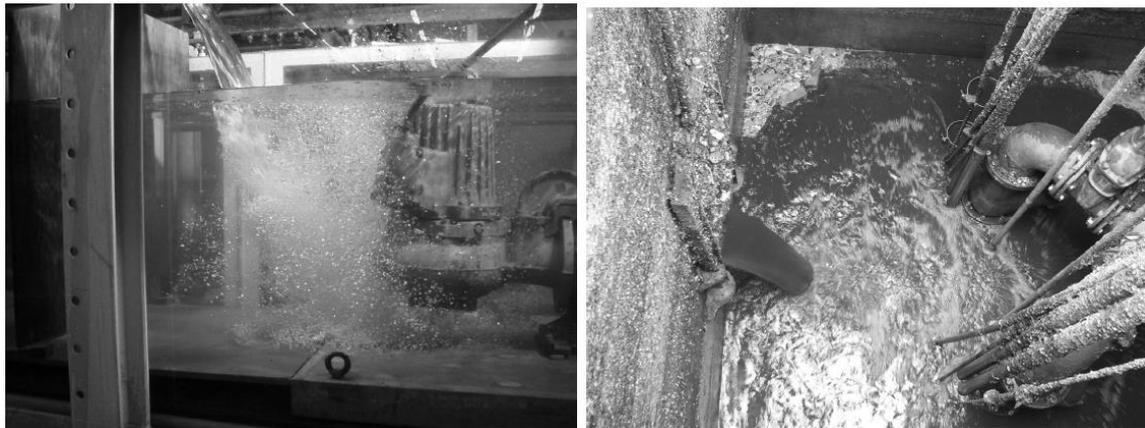
Abbildung 68: Darstellung des Lufteintrages in den Pumpensumpf durch freien Auslauf im Pumpensumpf (links: Laborsituation, rechts: realer Pumpensumpf) (Pothof, 2011)
