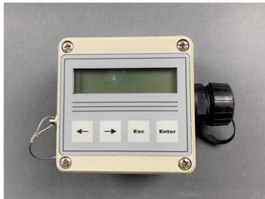
Abbildung 9: Verwendeter Datenlogger PWBlogg N6/5 der Firma Wegener
