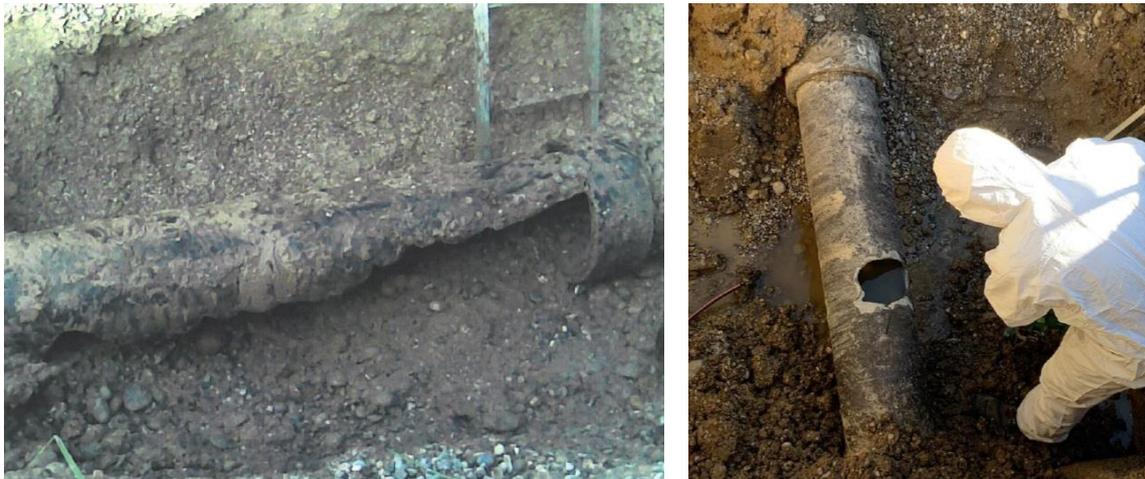
Abbildung 72: links: Scherbenbruch hervorgerufen durch defekten Druckminderer an Druckluftspülung - rechts: Schaden durch Dritte im Zuge einer Spülbohrung; (AWA)
