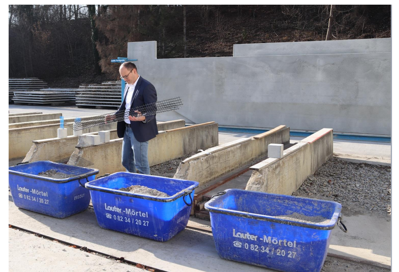
Prof. Dr.-Ing. Sergej Rempel erläutert die Bestandteile der Surfwellen: Die Carbonbewehrung (in seinen Händen) und der verwendete Recyclingbaustoff in den Behältern.
