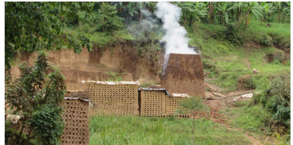
Brennen der Lehmziegel im Brennofen Firing the clay bricks in the kiln
