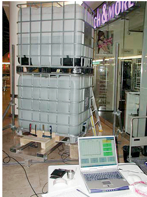
Belastungseinrichtung, eingesetzt in einem Einkaufszentrum
