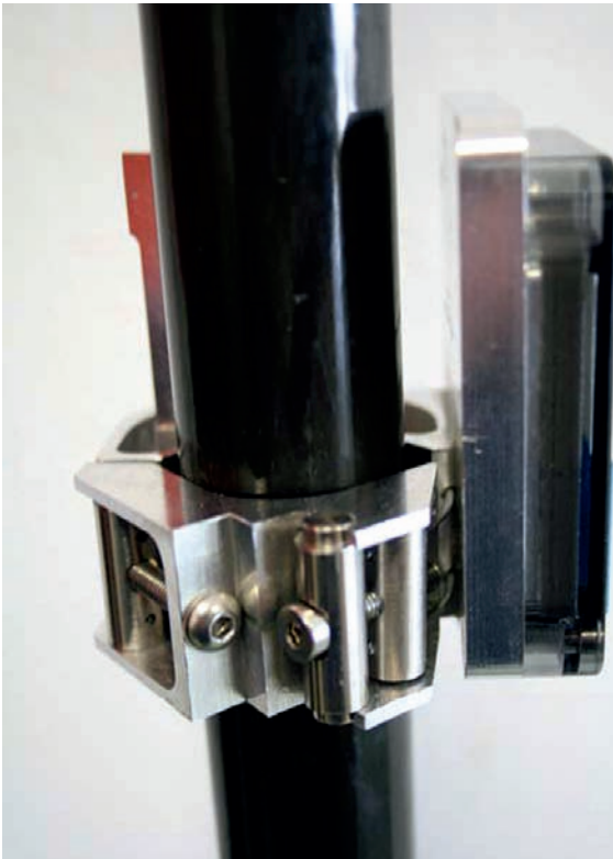
Klemmschelle zur Montage am Paddel
