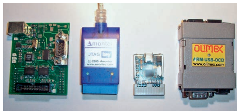
Abbildung 1: Verschiedene USB-zu-JTAG Adapter (von links): Mein Prototyp (a), Varianten JTAGkey (b) und JTAGkey- Tiny (c) der Firma Amontec, Variante ARM-USB-OCD der Firma Olimex (d).
