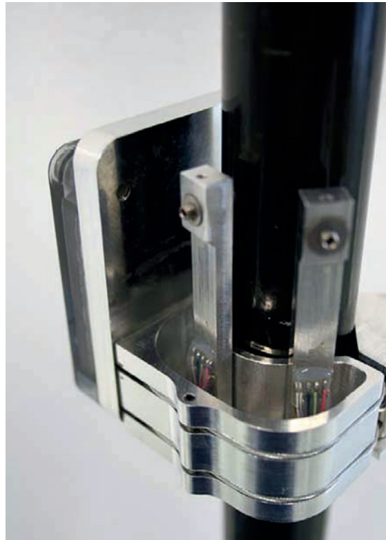
Biegebalken erfassen die Biegung des Paddelsschaftes
