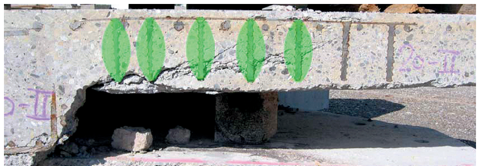
Bild 7: Versuchskörper mit modellhaft dargestellten Verbundankern
