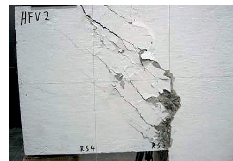
Bild 4: Bruchbild einer Konsole mit HFV-Zugbandbewehrung
