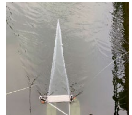
Im Test am Hanreibach in Augsburg: Ob Mikroplastik-Partikel im Wasser sind, lässt sich mit dem Kescher erproben. Foto: Tobias Dempfle
