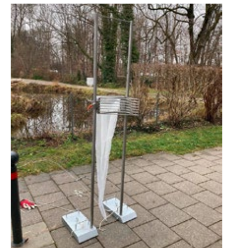
Zum Test bereit: Die Messeinrichtung zur Erfassung von Mikroplastik in Fließgewässern. Foto: Tobias Dempfle
