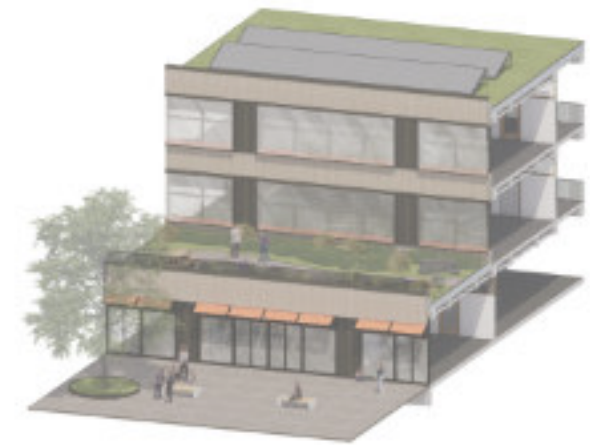
↑ Neue additive Fassadenhülle Neue Hülle wird direkt auf die Bestandsfassade geschraubt
