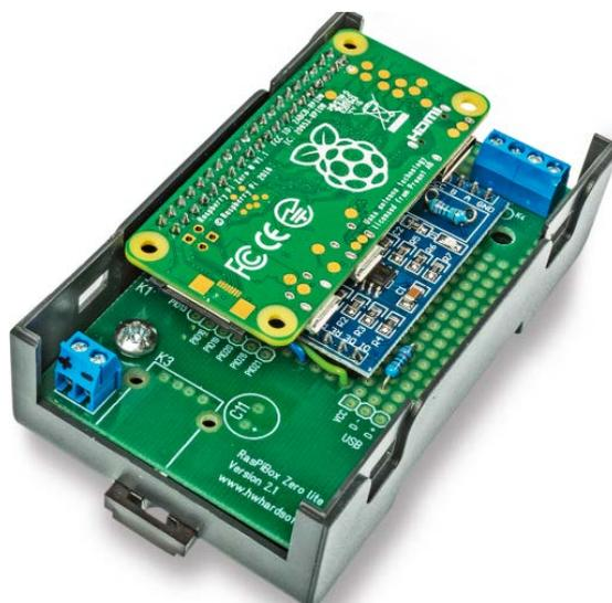
Der Raspi, hier das Modell Zero W in einem Hutschienengehäuse für den Schaltschrankbau, eignet sich prima für Steuerungsaufgaben. Dank Read-Only-Dateisystem übersteht er sogar Stromausfälle ohne Schäden an der MicroSD-Karte.
