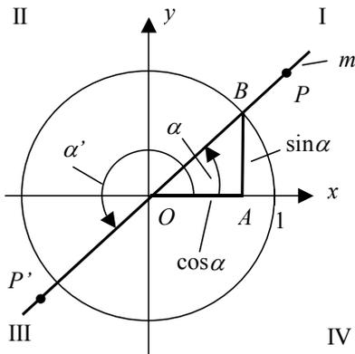
**Bild 2.5** Definition der trigonometrischen Funktionen im Einheitskreis
